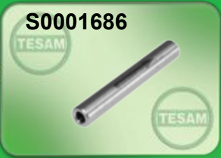
Tulejka blokująca elektrodę świecy żarowej podczas wiercenia 2.8 mm
