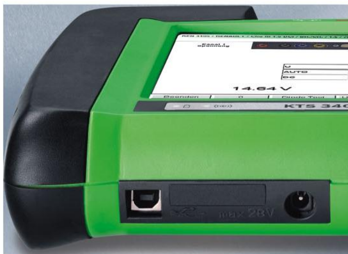
Gniazda: USB dla PC i drukarki, slot na karty i gniazdo zasilacza
